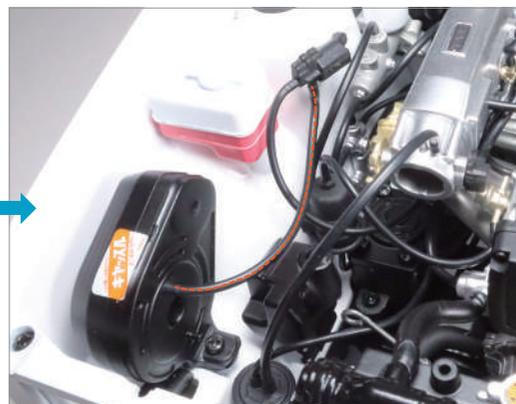
將步驟 3 中安裝到 50-C 的 50-K 插入怠速提升器電磁閥 37-D 下方的突起部分。
