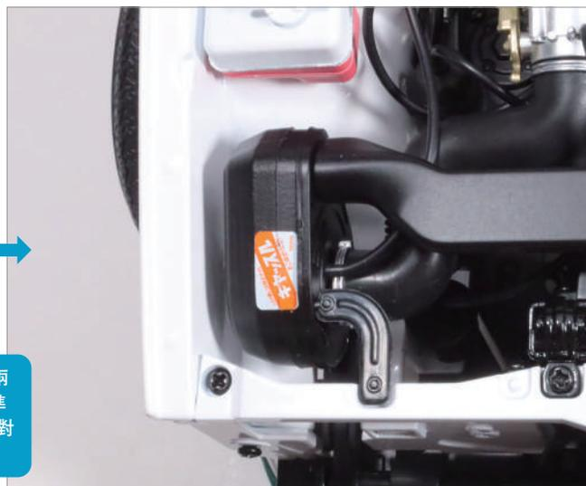
將空氣濾清器外殼支架 **50-F** 的兩個突起部分，分別對準 **50-C** 的洞孔和散熱器固定框 **49-A** 的缺口，然後嵌入其中。
