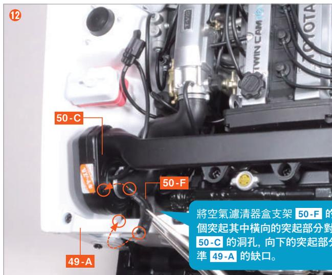
將空氣濾清器盒支架 **50-F** 的兩個突起其中橫向的突起部分對準 **50-C** 的洞孔，向下的突起部分對準 **49-A** 的缺口。
